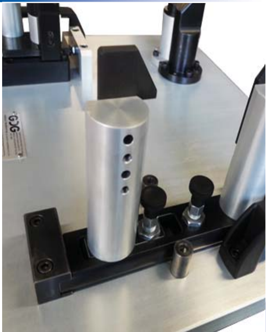
Fixtures y soportes de medición
